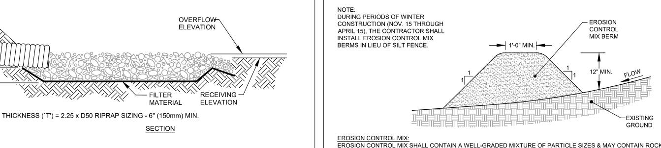
EROSION CONTROL MIX SHALL CONTAIN A WELL-GRADED MIXTURE OF PARTICLE SIZES & MAY CONTAIN ROCKS LESS THAN 4" IN DIAMETER. EROSION CONTROL MIX MUST BE FREE OF REFUSE, PHYSICAL CONTAMINANTS, AND MATERIAL TOXIC TO PLANT GROWTH. THE MIX COMPOSITION SHALL MEET THE FOLLOWING STANDARDS: THE ORGANIC MATTER CONTENT SHALL BE BETWEEN 80% - 100% DRY WEIGHT BASIS - PARTICLE SIZE BY WEIGHT SHALL BE 100% PASSING A 6" SCREEN AND A MINIMUM OF 70%, MAXIMUM OF 85% PASSING A 0.75" SCREEN
